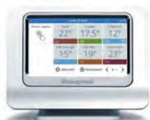
C'est l'élément central de votre système de chauffage. Il peut vous permettre, sous conditions, de programmer et de régler de manière intelligente le chauffage et l'eau chaude dans chaque pièce de votre habitation grâce à son écran tactile multicolore et son menu facile d'utilisation.
